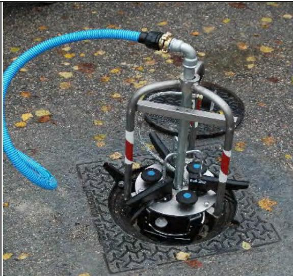
*Injektion von anaeroben Schadstoffabbauenden Bakterien unter Stickstoff (Quelle: F. KARG 2020).*
